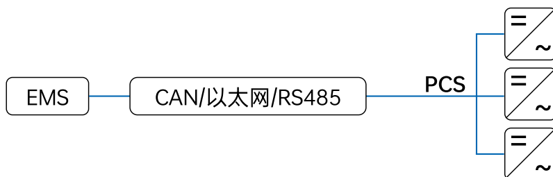
图 3-6 EMS 通过 CAN/ 以太网 /RS485 进行监控
