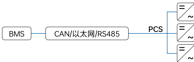
图 3-7 BMS 机通过 CAN/ 以太网 /RS485 进行数据传输
