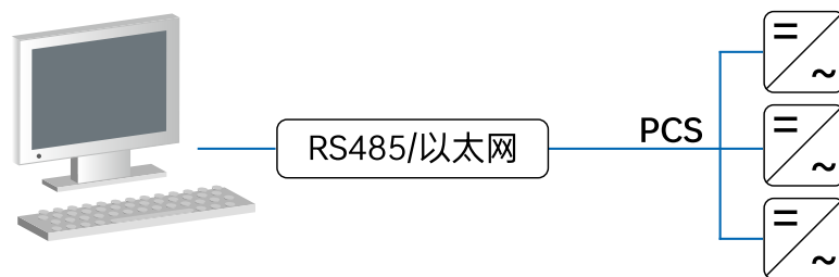
图 3-5 上位机通过 RS485 转换器 / 以太网进行监控
