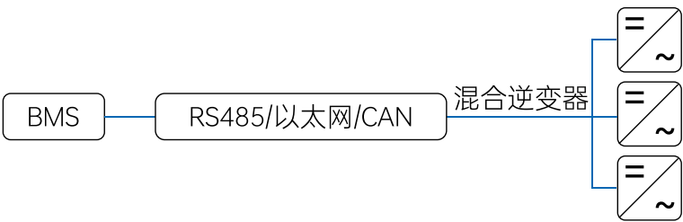
图 3-4 BMS 通过 CAN / 以太网 / RS485 通信
