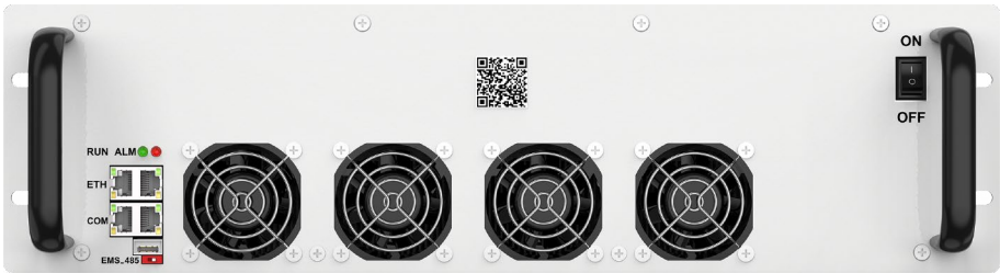
图 3-10 50kW、62.5kW 变流器信号接口
